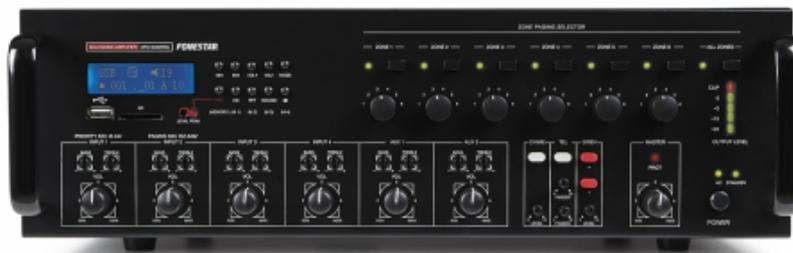
Amplificador de zonas. 6 zonas con control independiente de volumen, máximo 120 W por zona. Reproducción de hasta 6 mensajes pregrabados. Grabador/reproductor USB/SD/MP3. Sintonizador digital de radio FM. Memoria interna para almacenar mensajes y tonos musicales de aviso. Alimentación phantom. Prioridad de avisos. Conexión hasta 3 micrófonos con selector de zonas MZ-648 y 3 micrófonos con prioridad M-64.
